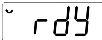
Figura 5.1: Display de la HMI al energizar
